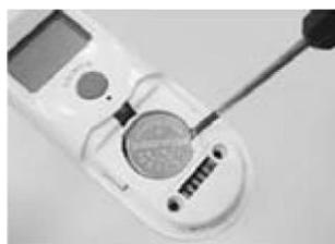
3. Insérez la nouvelle pile sous l'ergot métallique se trouvant sur le côté gauche ① et appuyez sur le côté droit ② de la pile jusqu'à ce qu'elle se clipse en place.
